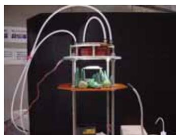
図 2.1 小型の磁気浮上制御技術開発システム
