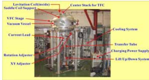
図 17 Mini-RT 装置の外観
