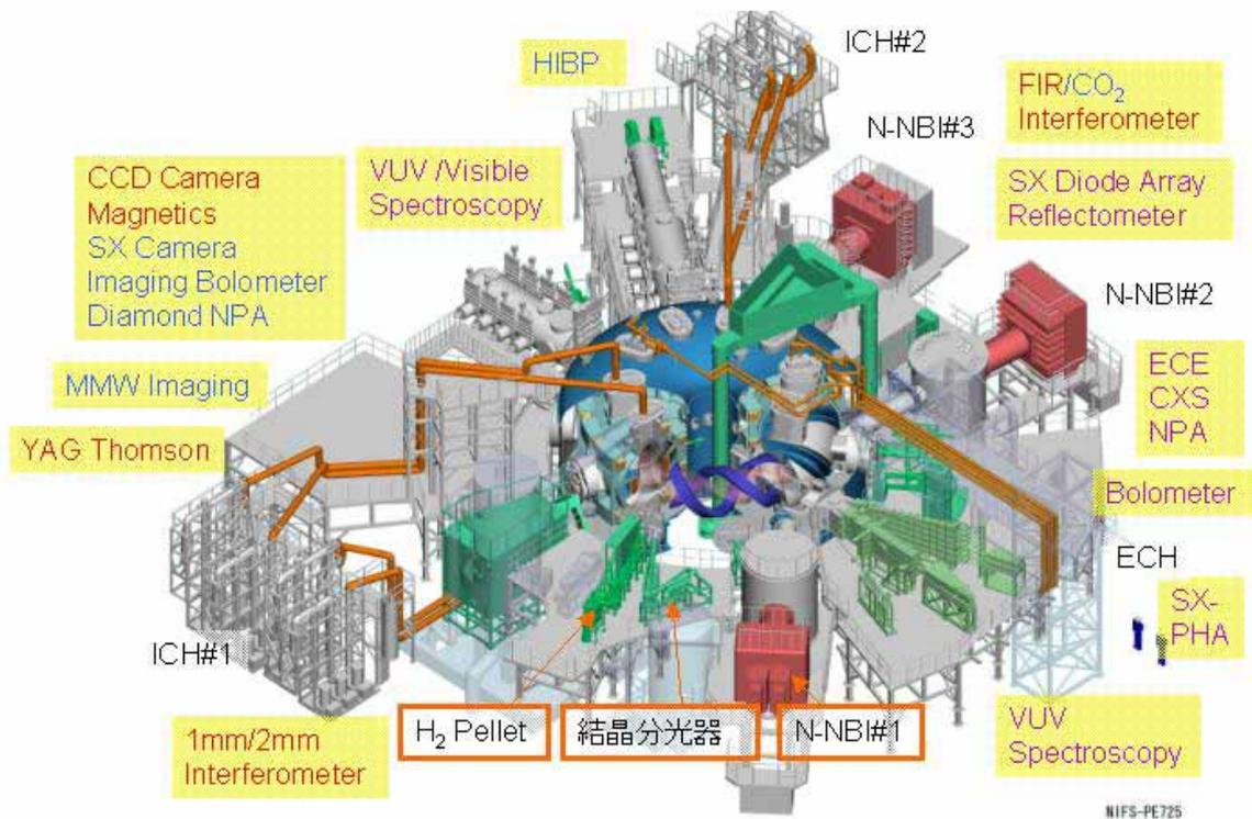
図3 LHD 計測装置群 ( 1ショット当たり約 1GB のデータ量が生み出される )
