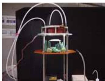
小型の磁気浮上制御技術開発システム（左：超小型高温超伝導磁気浮上コイルを用いた浮上制御実験、右：永久磁石を用いた浮上制御実験）
