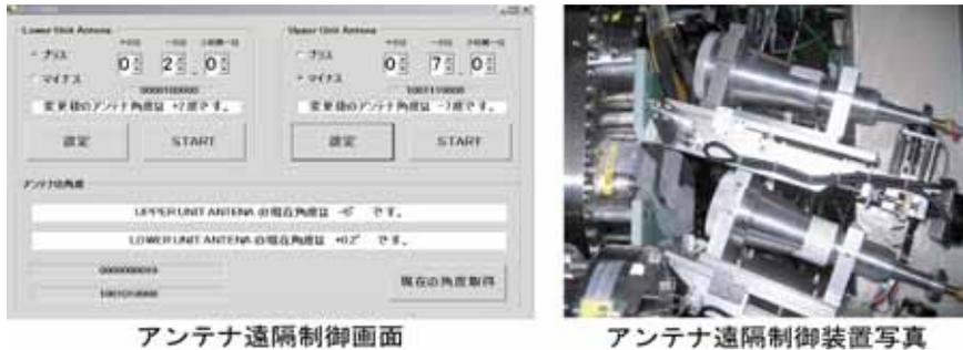
図3-2 反射計アンテナ本体およびアンテナ角度遠隔制御操作GUI画面
