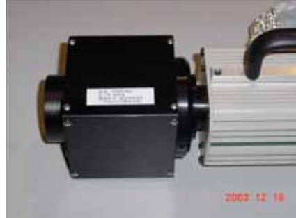
図 6-1 強磁場対応リモートレンズ駆動装置
